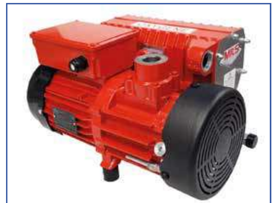
Pompe à vide EVISA E40 spéciale oxygène Débit : 40 m 3 /h, moteur : 1,1 kW
