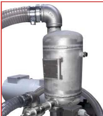
**Dispositif de recyclage partiel en option pour réduire de moitié le volume d'eau froide nécessaire. Coûts d'exploitation inférieurs grâce à moins d'eaux usées qu'en mode de fonctionnement à eau perdue.**
